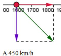
*Al lanzar el paquete desde una misma altura, la velocidad con la que llegue a destino y la distancia que recorrerá horizontalmente, antes de llegar al suelo/agua dependerá de la velocidad con que vuele el avión al momento de lanzarlo.*
